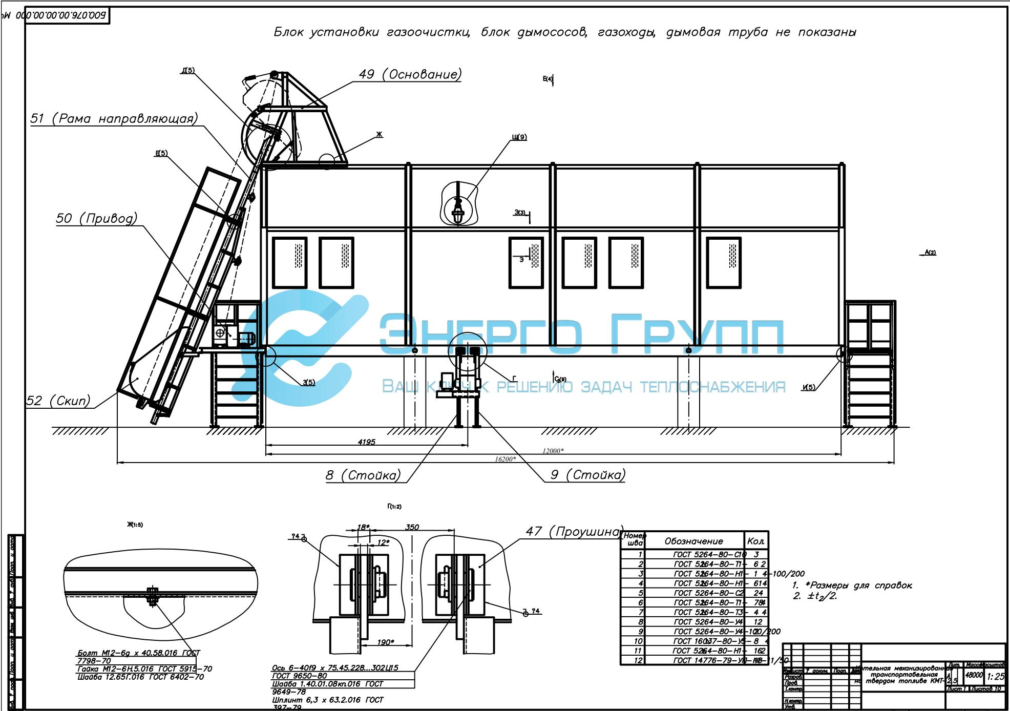
Блок установки газоочистки, блок дымососов, скребковый транспортер, газоходы, лестницы, панели покрытия условно не показаны
